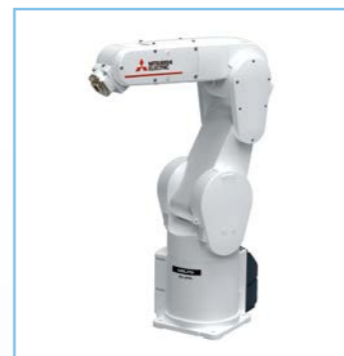
RV-4FRL-D/Q/R 可搬重量：4kg 最大可達半徑：649mm
