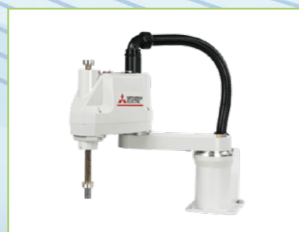
RH-3CRH4018-D 可搬重量：3kg 最大可達半徑：400mm
