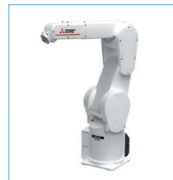
RV-7FRL-D/Q/R 可搬重量：7kg 最大可達半徑：908mm
