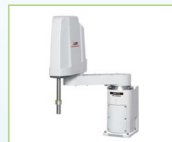
RH-6FRH55** -D/Q/R 可搬重量：6kg 最大可達半徑：550mm
