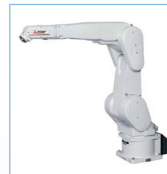
RV-7FRL-D/Q/R 可搬重量：7kg 最大可達半徑：1503mm
