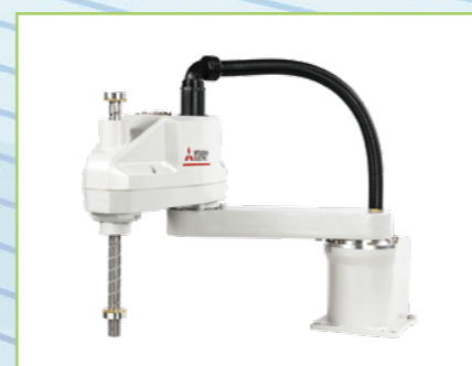
RH-6CRH6020-D 可搬重量：6kg 最大可達半徑：600mm
