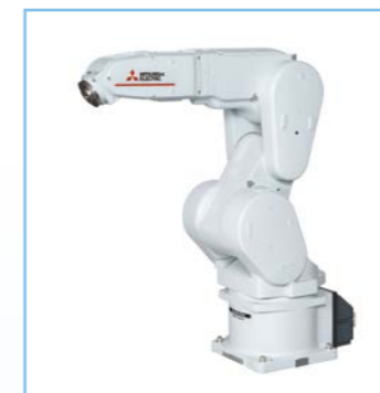
RV-13FR-D/Q/R 可搬重量：13kg 最大可達半徑：1094mm
