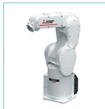
RV-4FR-D/Q/R 可搬重量：4kg 最大可達半徑：515mm
