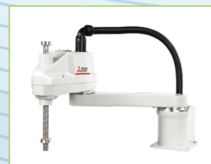
RH-6CRH7020-D 可搬重量：6kg 最大可達半徑：700mm
