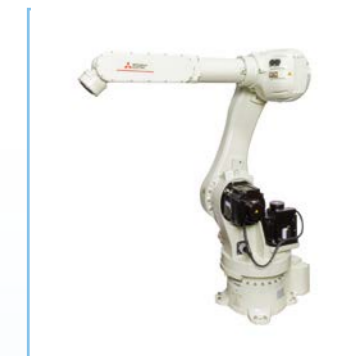
RV-35FR-D/Q/R, RV-50FR-D/Q/R, RV-80FR-D/Q/R 可搬重量：35kg/50kg/80kg 最大可達半徑：2100mm
