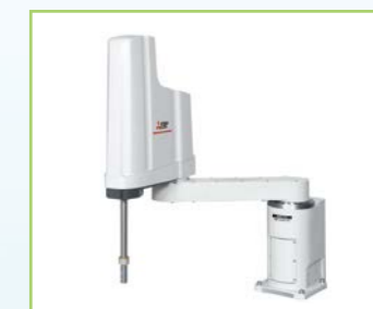
RH-20FRH100** -D/Q/R 可搬重量：20kg 最大可達半徑：1000mm
