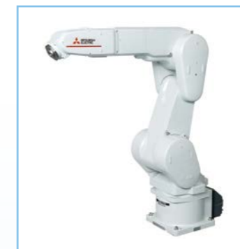
RV-13FRL-D/Q/R 可搬重量：13kg 最大可達半徑：1388mm
