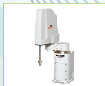
RH-3FRH35** -D/Q/R 可搬重量：3kg 最大可達半徑：350mm
