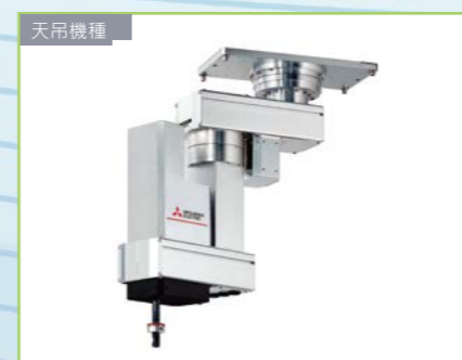
RH-3FRHR35** -D/Q/R 可搬重量：3kg 最大可達半徑：350mm 上下行程：150mm 無塵(ISO Class 5)・防水(IP65) 上下行程120mm
